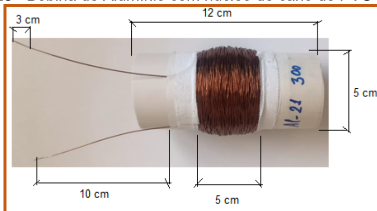
Figura 28 - Bobina de Alumínio com núcleo de cano de PVC de 50mm.
