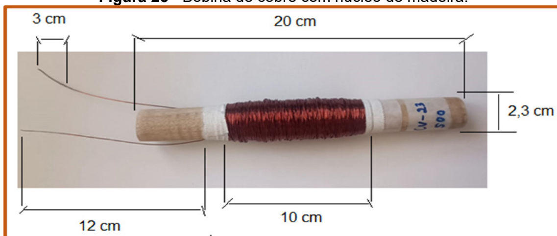
Figura 25 - Bobina de cobre com núcleo de madeira.
