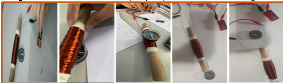
Figura 6 - Bússola em diferentes posições para detectar o efeito magnético
