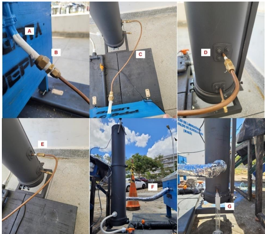
F: Isolamentos térmicos colocados em todo o sistema. G: Saída da água dessalinizada fria, após trocar calor, pela serpentina de cobre, com a água salobra.
