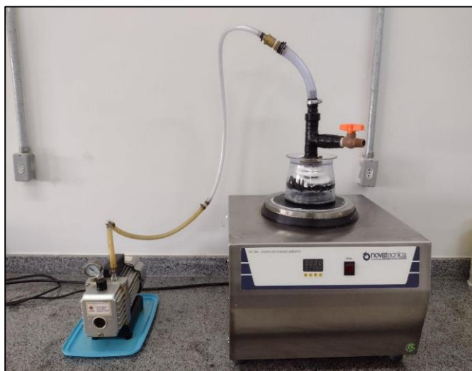
Figura 6 Sistema de liofilização utilizado na síntese das espumas.
