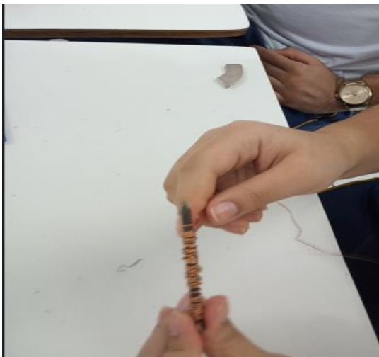
Figura 12 – Montagem incorreta do eletroímã.
