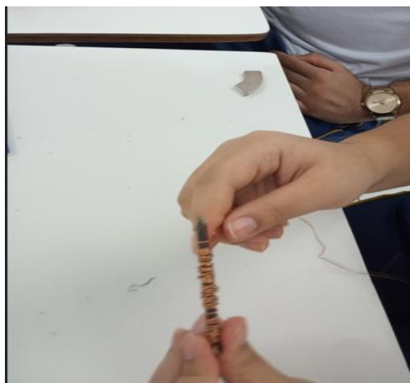
Figura 15 – Montagem incorreta do eletroímã.
