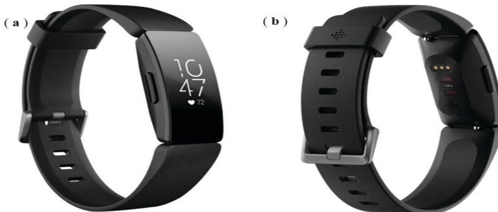
Figura 2. Dispositivo smartwatch utilizado no estudo. (a) vista superior com LED de status, (b) vista inferior (de frente para a área de medição).
