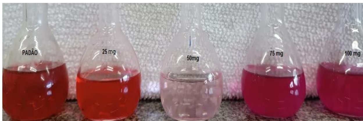
Figura 19 - Bent C16-3h- 60^\circ\text{C} após o a adsorção com variação da massa do adsorvente
