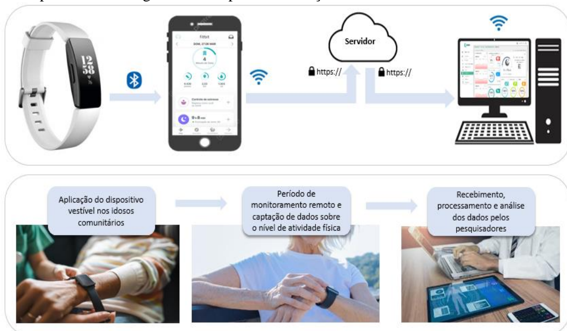
Figura 9. Arquitetura e composição geral do sistema de monitoramento remoto utilizando-se do dispositivo tecnológico vestível para mensuração do nível de atividade física.
