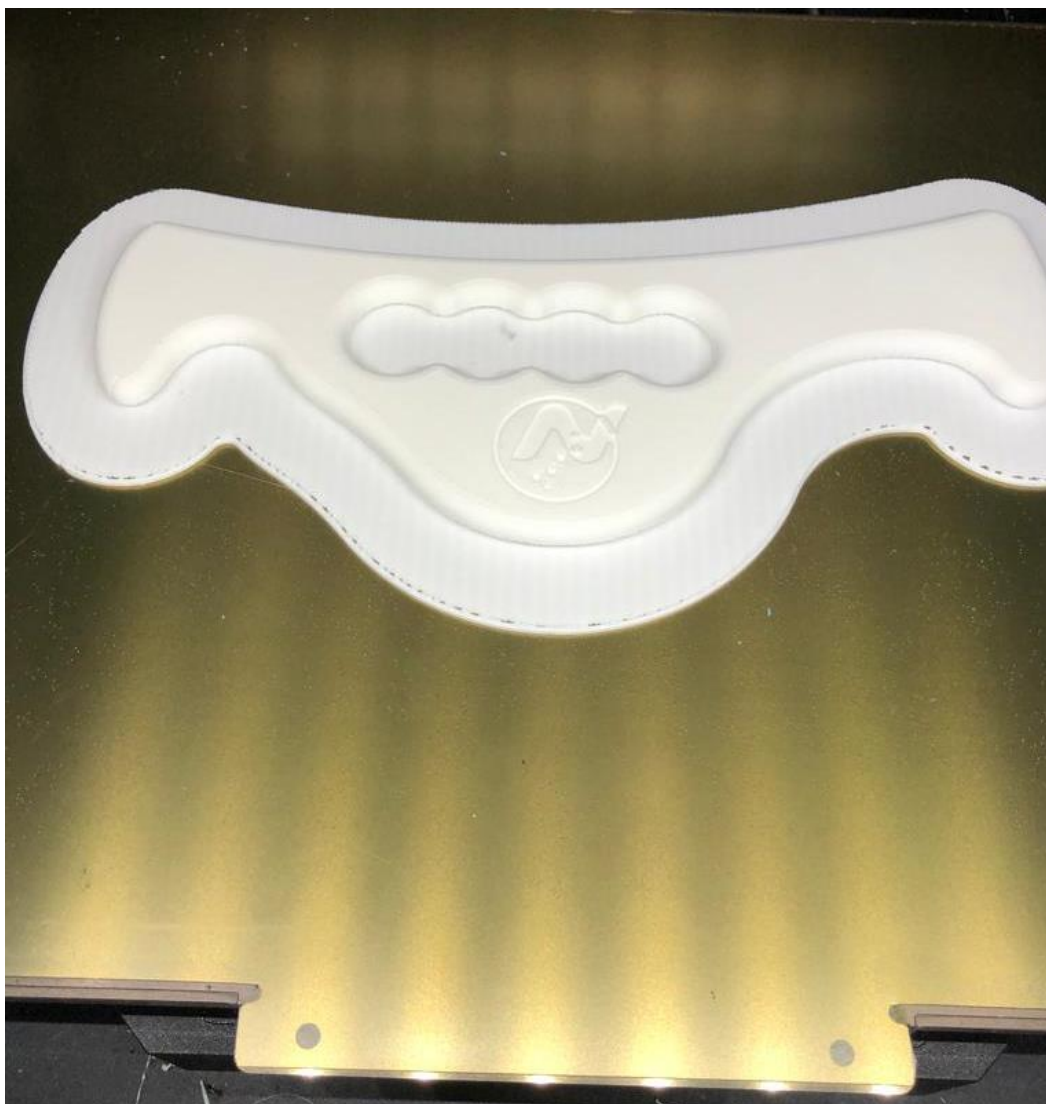
FIGURA 35 – Dispositivo posicionado na bandeja de impressão, após finalização da fabricação.
