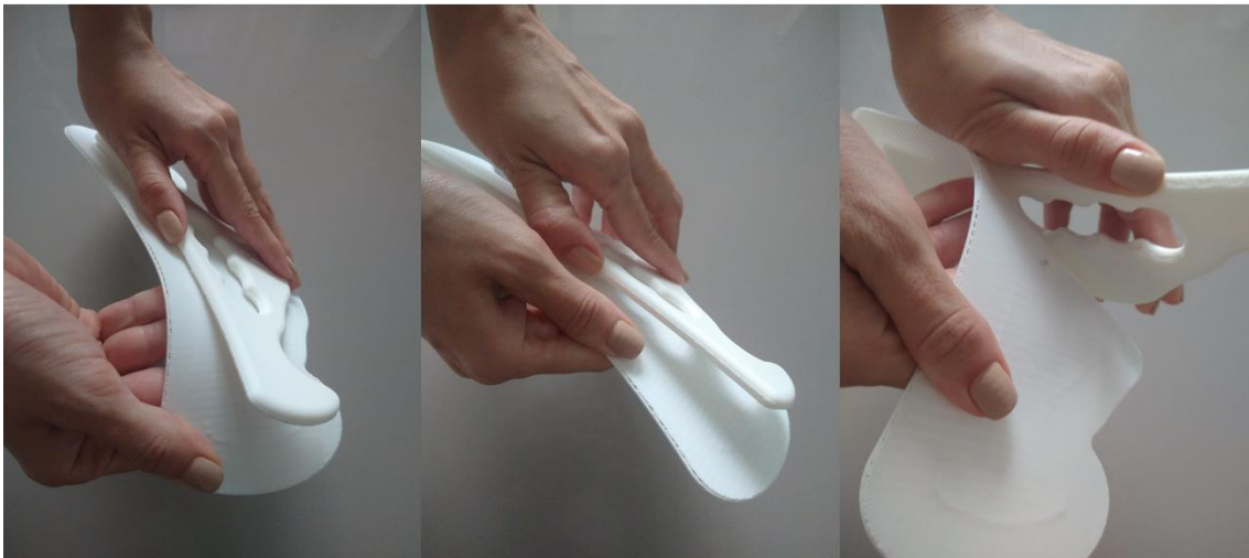
FIGURA 36 – Raft do dispositivo sendo retirado.
