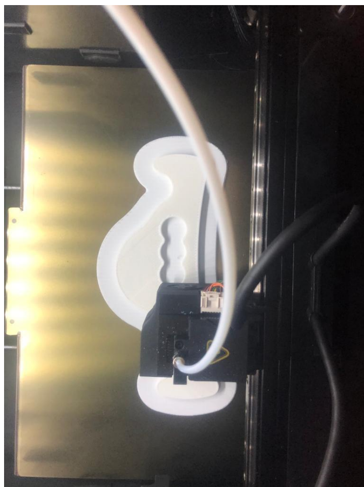
FIGURA 32 – Foto interna da impressora Raise 3D manufaturando o dispositivo.
