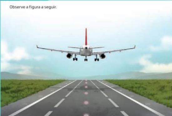
Nela, podemos observar uma pista de pouso com faixas contínuas laterais, que indicam os limites da pista, e pequenas lâmpadas, que demarcam a parte central.
