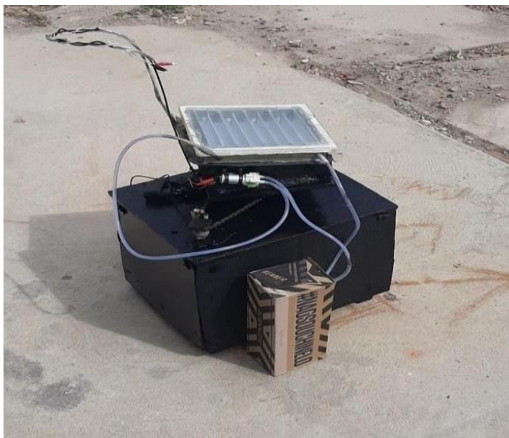
Figura 4.4 Protótipo reator fotocatalítico com radiação UV natural (sem oxigenação), etapa 2.
