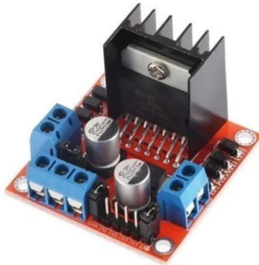
Figura 2 - Visão geral da Ponte H dupla L298n
