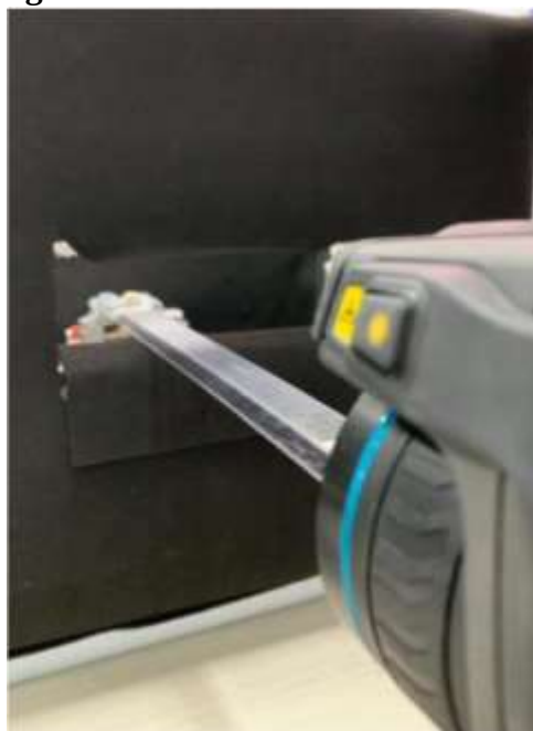
Figura 6 - Distância da lente à amostra.
