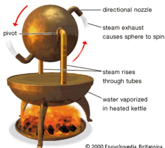
Figura 3 – Máquina a vapor de Heron de Alexandria
