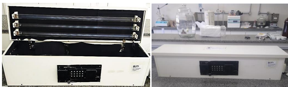
Figura 10 - Câmara de radiação utilizada para os ensaios de fotocatalise
