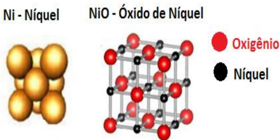
Figura 6 - Estrutura cristalina cúbica de face centrada do Ni e do NiO
