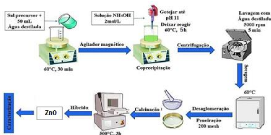
Esquema experimental para a síntese e obtenção do ZnO puro
