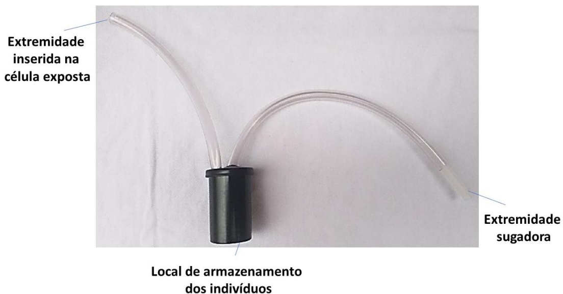
Figura 2 – Aspirador entomológico manual utilizado na coleta de cupins durante atividade de reparo em ninho de Constrictotermes cyphergaster .
