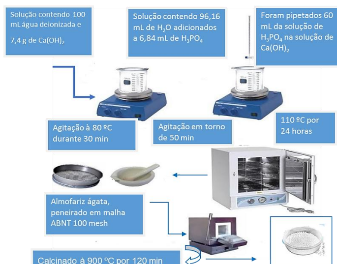
Figura 7 - Fluxograma da obtenção da HAp de laboratório e HAp calcinada (Araújo et al. , 2018).
