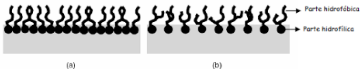
Figura 3 - Esquema do processo de adsorção com moléculas tensoativas: (a) a maioria das cadeias hidrofóbicas apresenta característica linear, (b) múltiplas cadeias hidrocarbônicas.
