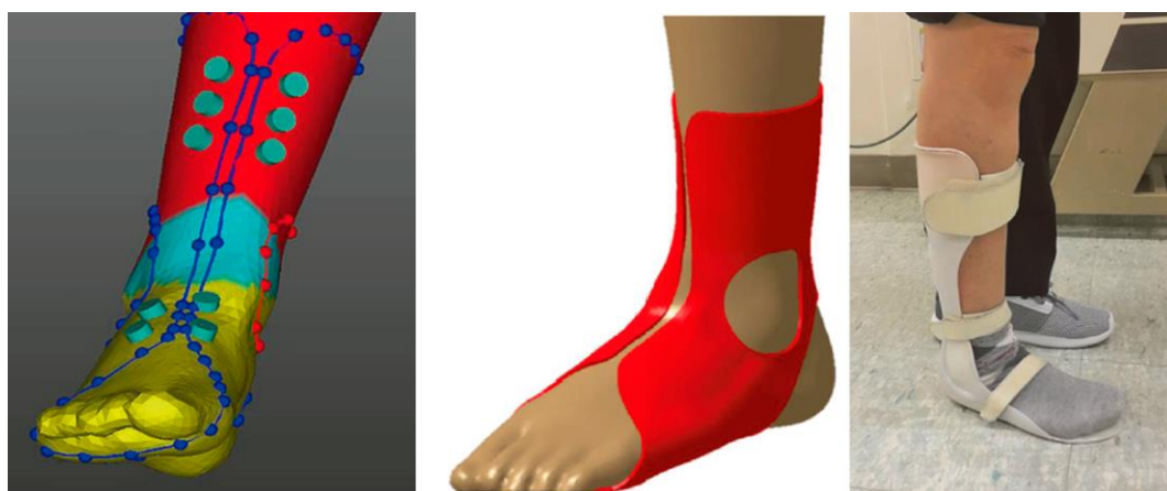
Figura 66 - Procedimento do scan ao protótipo.
