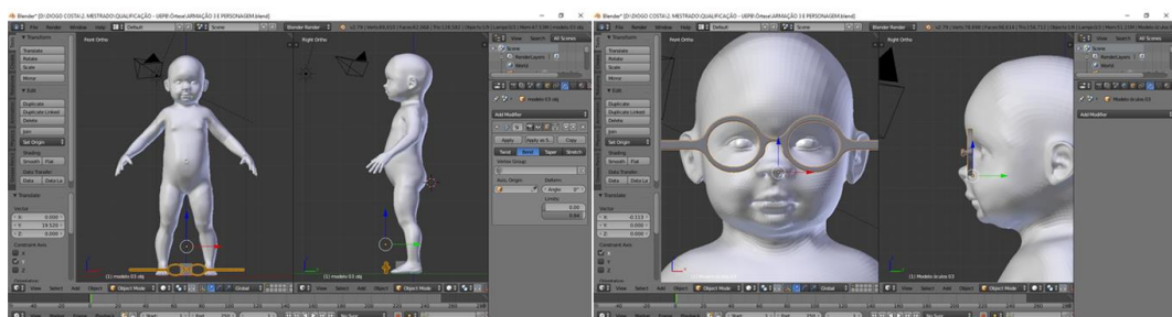
Figura 50 - Ajustar a escala para impressão 3D
