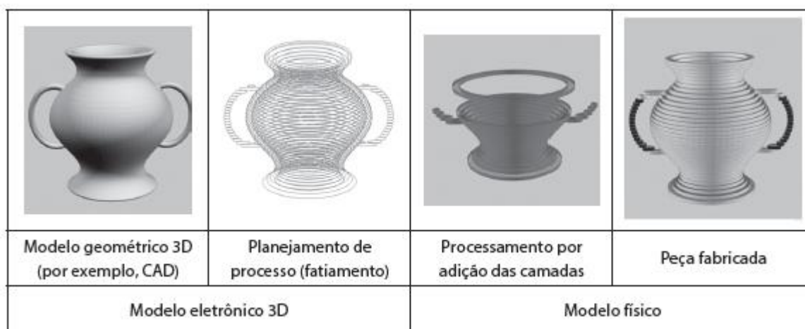
Figura 2 - Representação das principais etapas do processo de AM.
