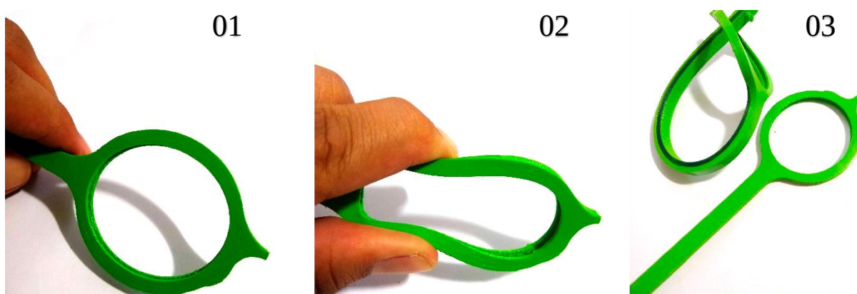
Figura 53 - Impressão 3D do Prototipo. 01- Parte da peça extraída; 02 e 03- Mostra da flexibilidade do material.
