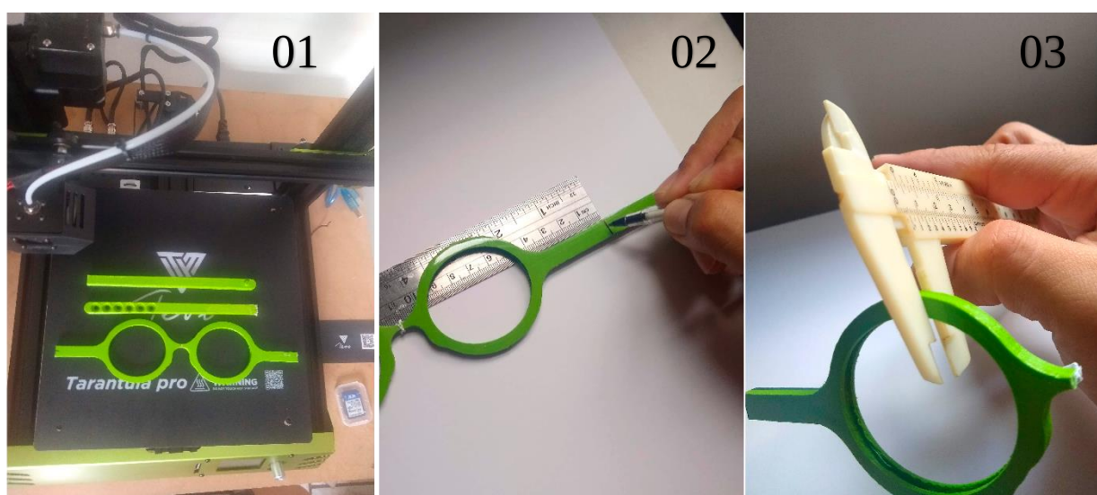
Figura 56 - Planejando nova orgaização de impressão. 01- Organização correta na base da impressora; 02- Mensuração da determinar posição e corte; 03- Mensurando partes da armação.
