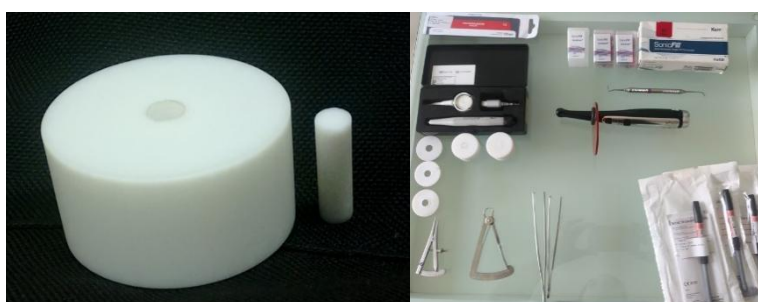
Figura. 4. Confeção dos disco de resinas, a partir de uma matriz de teflon pré-fabricada.
