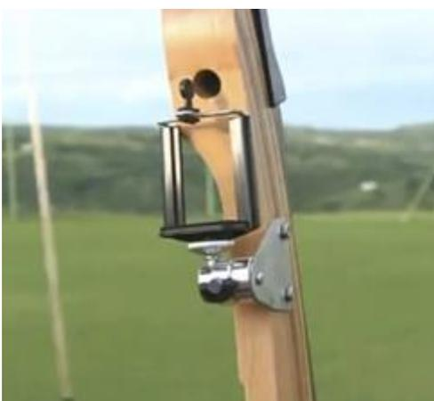
Figura 09. Acessório de fixação do smartphone, acoplado no local da mira do arco.
