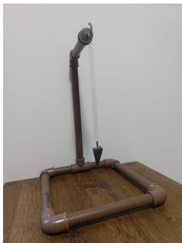
Figura 3 – Kit montado para experimento de oscilação de um sistema blocomola.
