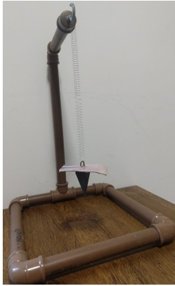
(a) Aparato experimental: oscilador bloco mola com aumento da área de resistência com o ar.
