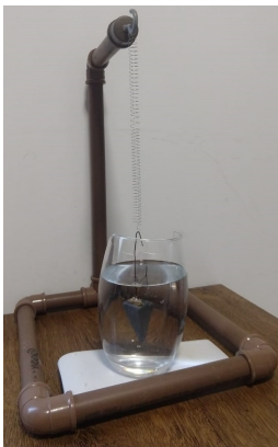
(a) Aparato experimental do oscilador blocomola imerso em água para intensificar o amortecimento.
