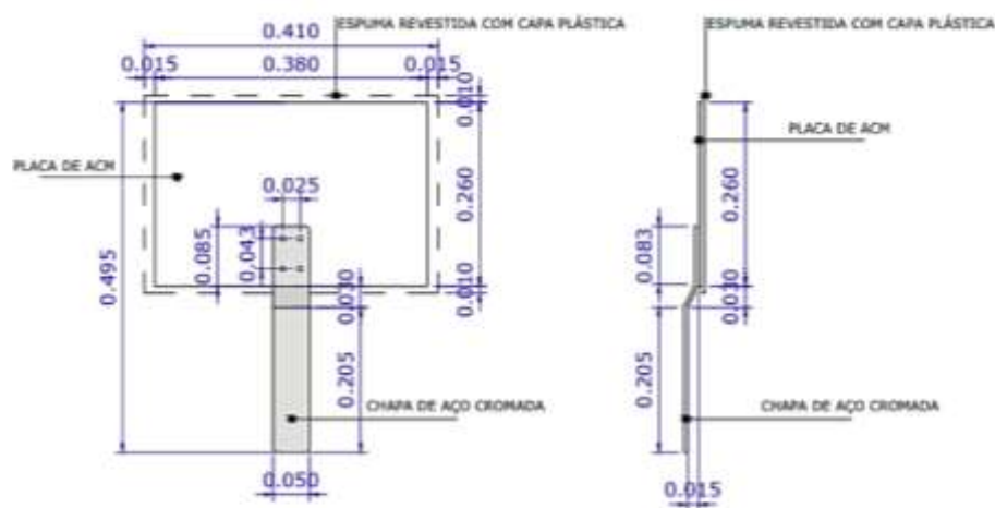
Figura 4 - Características e dimensões da placa de ACM, da Base do Imobilizador de cabeça e haste de ferro cromada do encosto de cabeça da cadeira odontológica.
