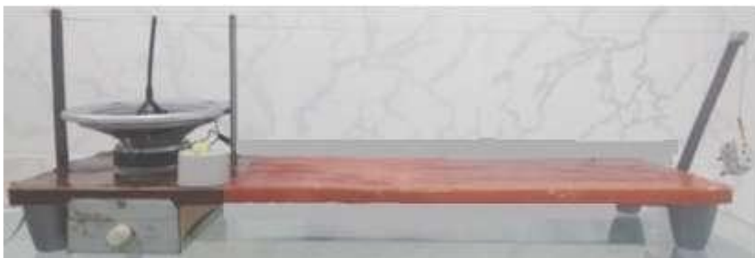
Figura 3. Demonstração do experimento sobre ondas estacionárias.
