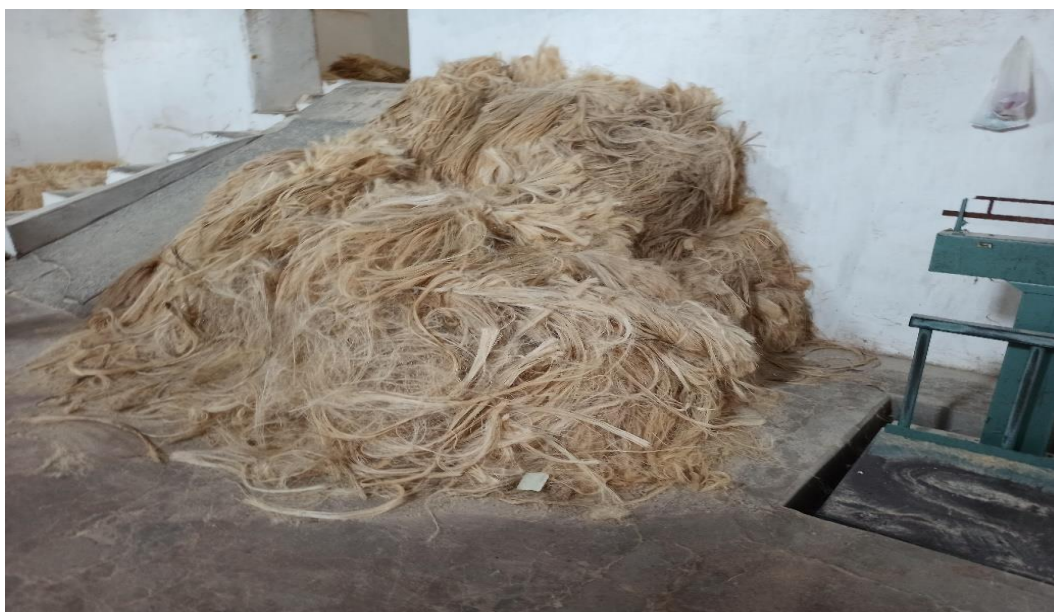
Figura 29. Vista de fibras de baixa qualidade usadas como bucha na aplicação de gesso.
