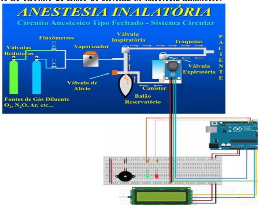
Figura 23. Disposição da placa Arduino compondo o sistema de medição de CO com o sensor de CO disposto no circuito de fluxo do sistema de anestesia inalatório.
