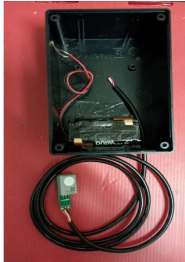
Figura A3 – Sistema de captação do monóxido de carbono no processo de anestesia.
