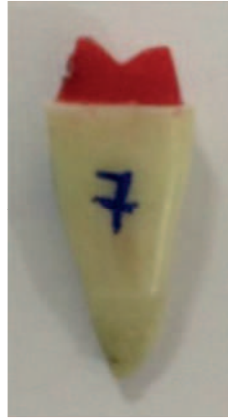
Figura 12. Padrão para fundição em resina acrílica Duralay.
