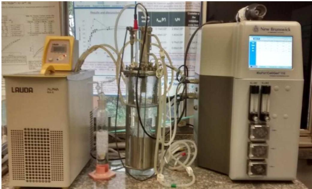
Para calcular o coeficiente volumétrico de transferência de oxigênio ( $k_La$ ) foi utilizado o método dinâmico de acordo com Wise (1951) e Riet (1979), que utiliza a medição, por meio de eletrodo, da concentração de oxigênio dissolvido na água. O biorreator foi preenchido com 5 L de água destilada e foi utilizada a temperatura de 30 °C sob pressão atmosférica.
