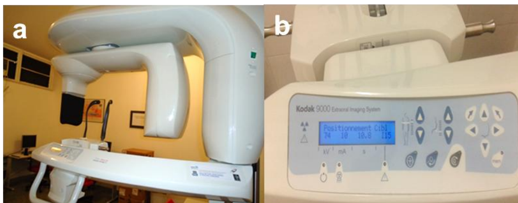
Figura 06: (a) Aparelho da Kodak 9000 e (b) painel com visor mostrando os botões de ajustes do aparelho.
