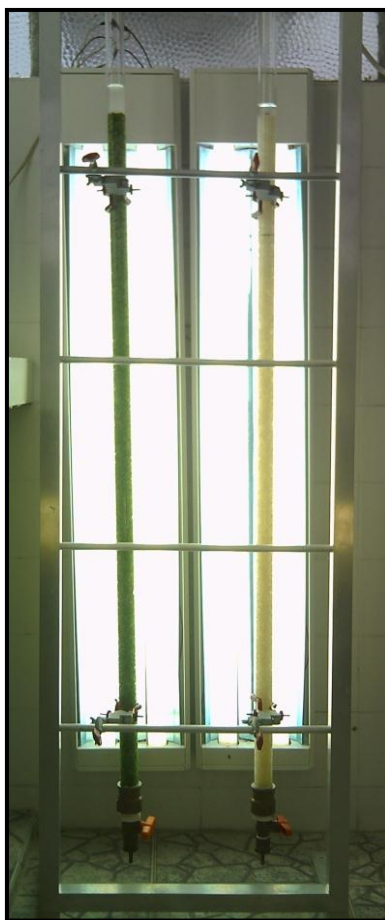
FIGURA 12: Bioreatores- Etapa II, microalgas e controle
