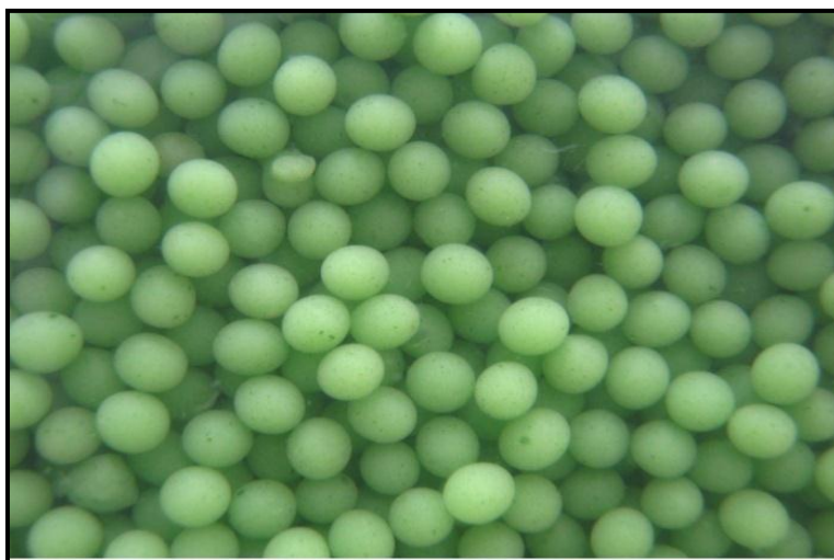
FIGURA 6-a: Esferas com algas imobilizadas
