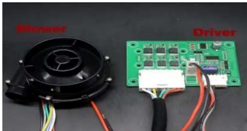
Figura 15- Mini turbina e driver controlador
