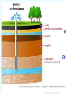
Poço artesiano é um tipo de poço tubular profundo que é escavado no subsolo com a finalidade de captar água para o consumo humano. O poço artesiano é uma solução econômica, de qualidade e que tem uma longa vida útil.
