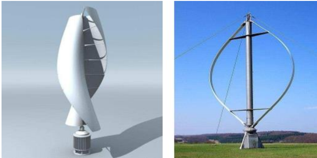
Figura 2. Vistas de turbinas de eixos verticais de Darrieus e Savonius, respectivamente
