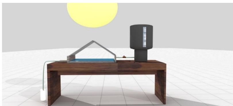
Figura 10 - Esquema do dessalinizador solar piramidal com alimentação contínua por gravidade.
