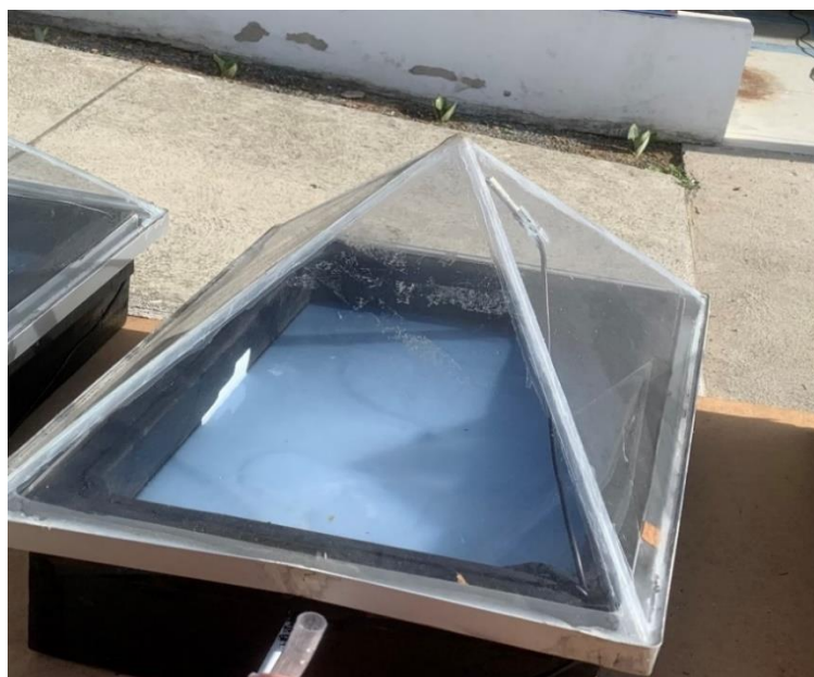
Figura 9 - Dessalinizador solar do tipo pirâmide com o \text{TiO}_2 na água salobra.
