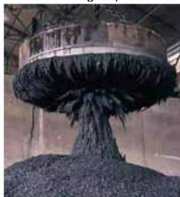
Figura 3: O eletroímã da foto é usado para transportar sucata em uma fundição. (Digital Vision/Getty Imagens).
