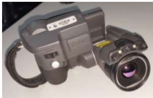
FIGURA 4 - Câmera portátil de sensor infravermelho FLIR modelo T650sc Infrared
