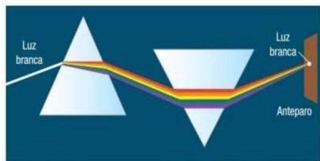
Figura 6 - Esquema representando a decomposição e recomposição da luz branca, utilizando dois prismas, em Física e Interação e Tecnologia
