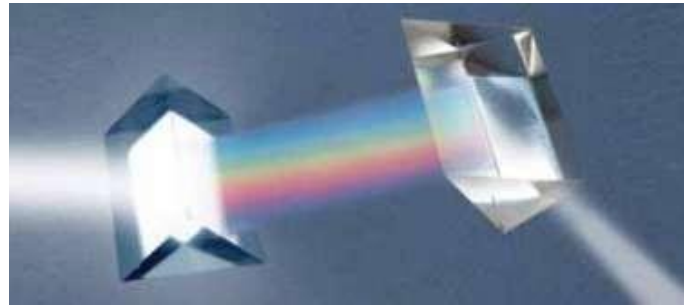
Figura 12 - O segundo prisma combina as cores de modo que a luz branca retorne em Conexões com a Física
