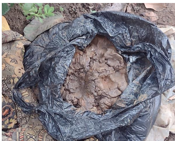
Figura 17 – Formação do bolão de barro pela adição de água
