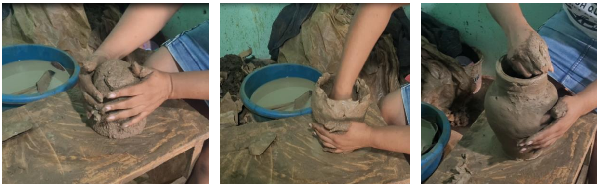
Figura 20 – Formação do corpo de uma peça em barro, indo desde a formação do bolo, aos movimentos de mãos para dar o formato desejado até o tratamento de bordas
