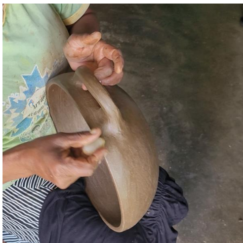
Figura 11 – Prática de raspagem realizada na porta de uma das residências
