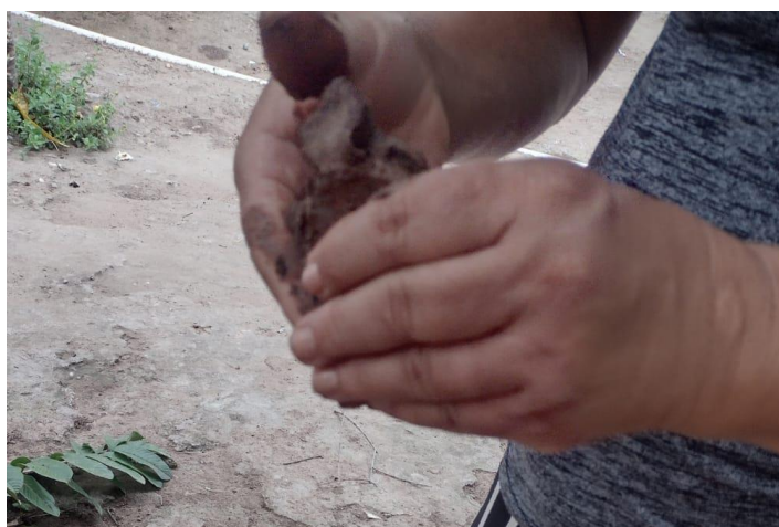
Figura 18 - Teste da liga obtida a partir da adição de água ao barro
