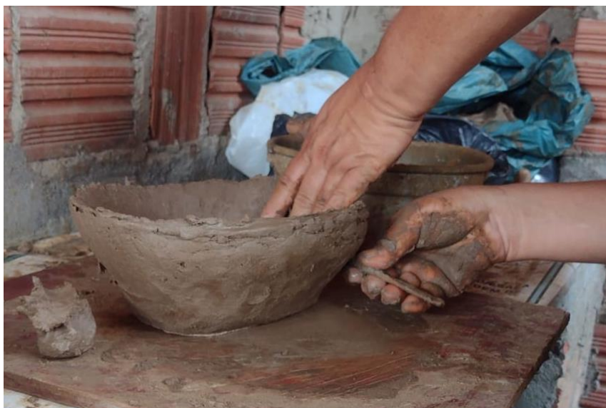
Figura 21 – Técnica de alisar empregada por louceiros(as) de Chã da Pia
