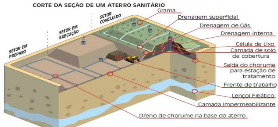
Figura 1 - Figura esquemática da estrutura de um aterro sanitário
