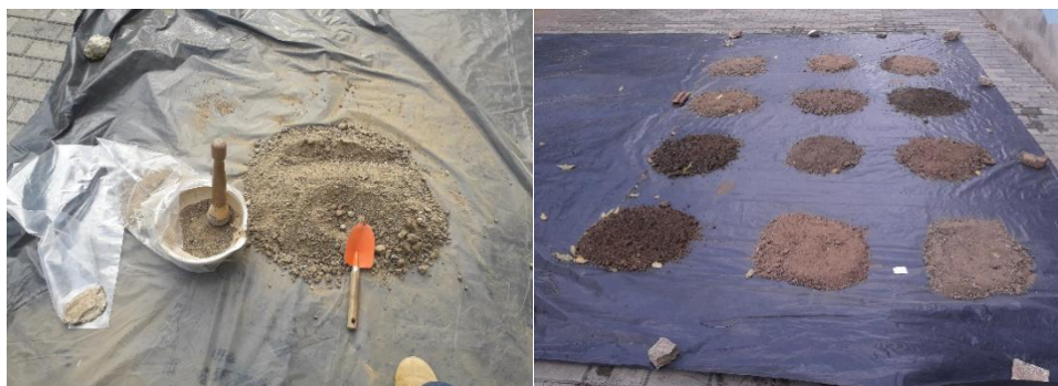
Figura 18 – Fotos dos procedimentos iniciais para as análises de solo (secagem prévia ao ar livre e destorroamento)
