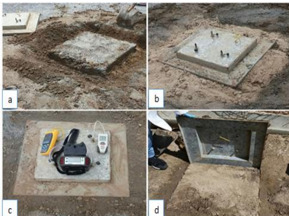
Figura 20 – Fotografias do ensaio com placa de fluxo tipo estática
