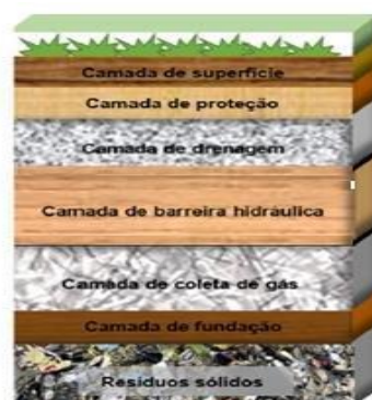
Figura 2 - Camadas de cobertura de solos utilizadas em aterro sanitário
