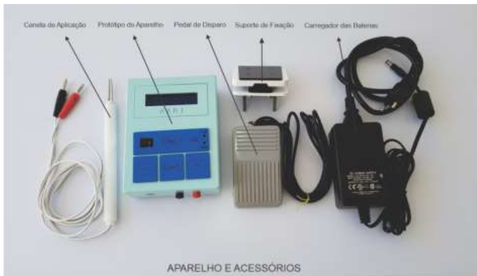
Figura 8 – Visão geral do aparelho e seus acessórios
