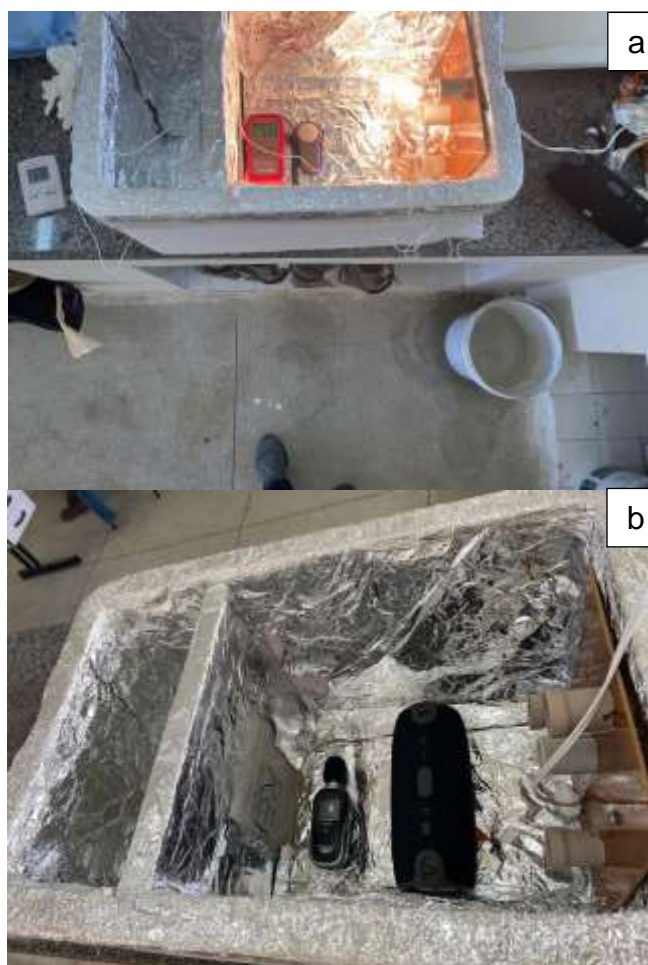
Figura 12 – (a) Caixa adaptada do estudo de Barros (2018), (b) montagem para esquema de análise acústica – Fonte de ruído + decibelímetro.
