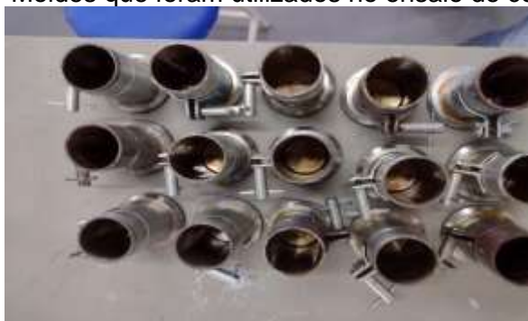
Figura 6 - Moldes que foram utilizados no ensaio de compressão
