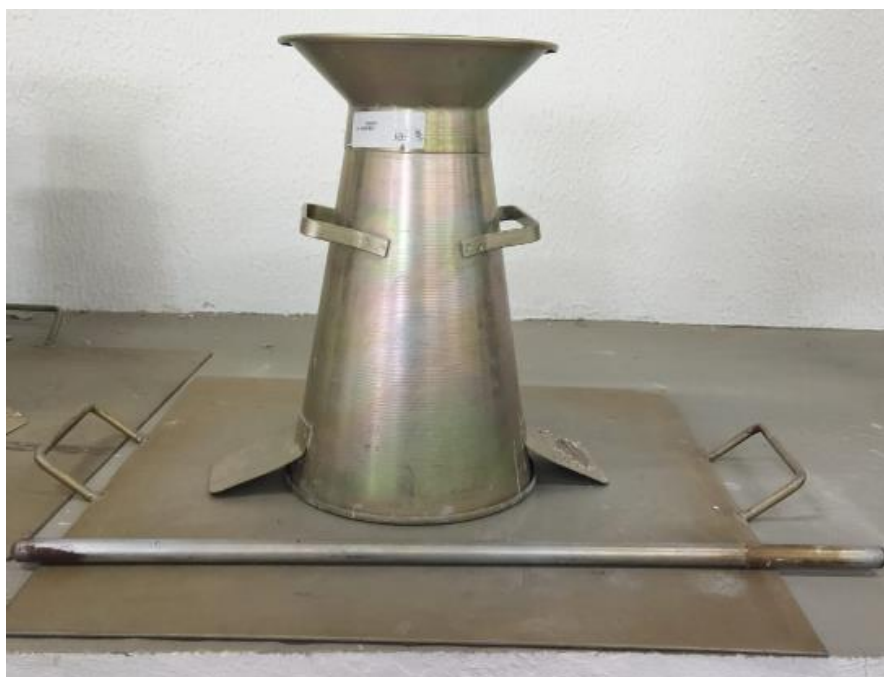
Figura 13 – Materiais utilizados para abatimento de tronco de cone
