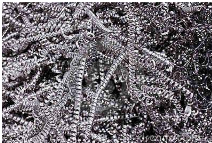
Figura 5 – Cavaco de aço tubulares
