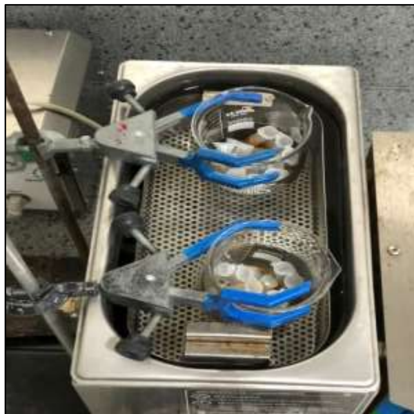
Figura 4 – Banho ultrassônico prévio ao procedimento de contaminação
