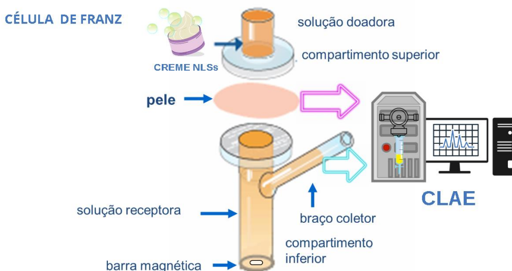
Figura 6 - Esquema representativo do ensaio de permeação/retenção usando célula de Franz.
