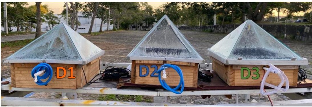
Figura 21 – Protótipos construídos de dessalinizador solar tipo pirâmide assimétrico.
