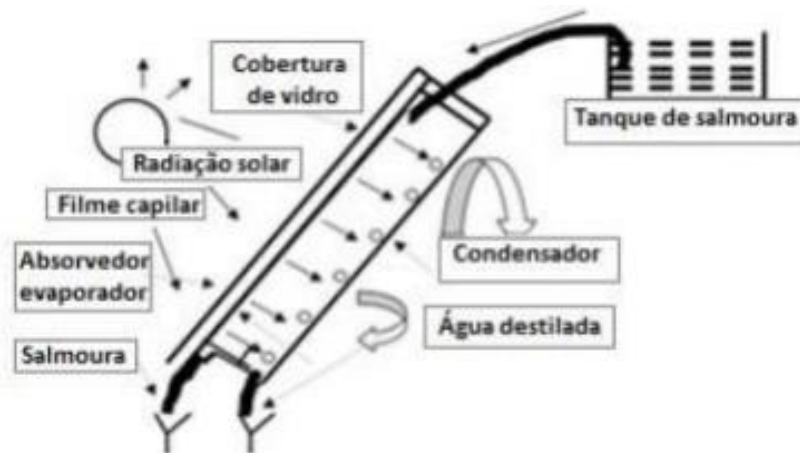
Figura 13 – Dessalinizador solar do tipo filme capilar
