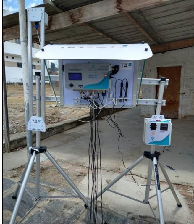
Figura 22 – Sistema Integrado de medição de parâmetros operacionais.
