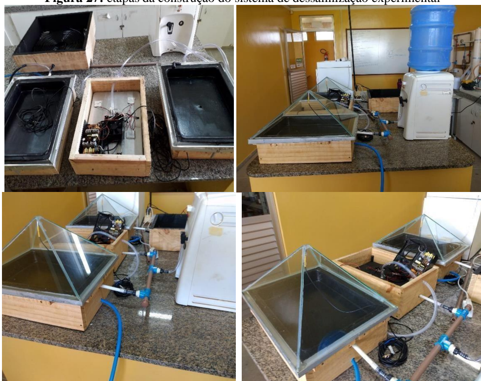
Figura 27: etapas da construção do sistema de dessalinização experimental
