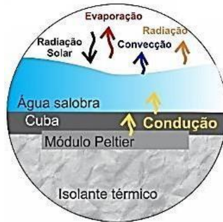
Figura 22: Balanço de energia para a água do dessalinizador
