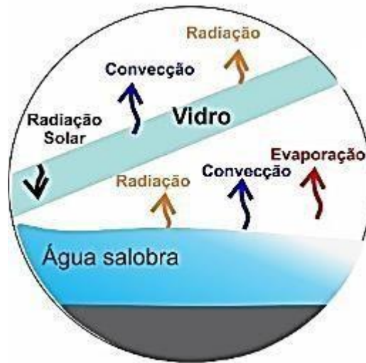
Figura 21: Balço de energia da cobertura de vidro do dessalinizador
