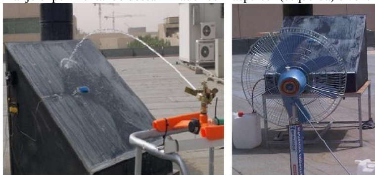
Figura 08: Arranjo experimental do dessalinizador com aspersor (esquerda) e ventilador (direita)
