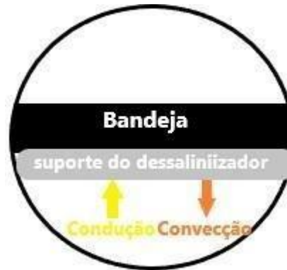
Figura 24: Balanço de energia para o isolante do dessalinizador
