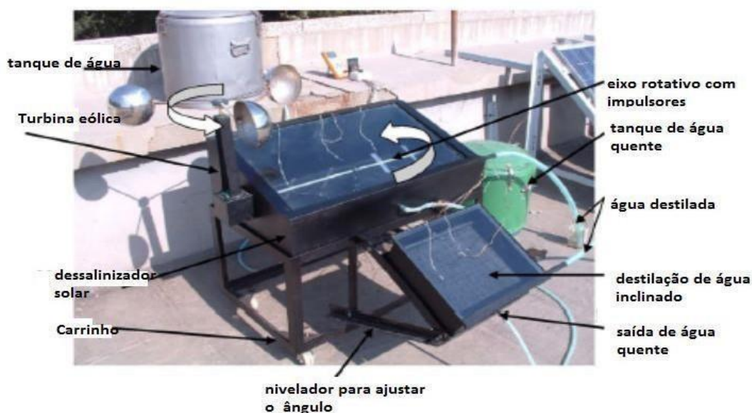
Figura 15: Componentes do dessalinizador solar
