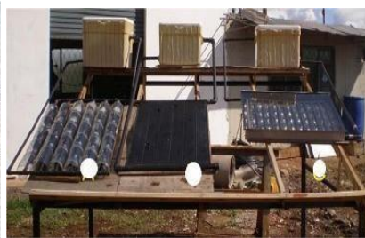
Figura 19: Coletor solar em espiral, plano e tubular para aquecimento de água
