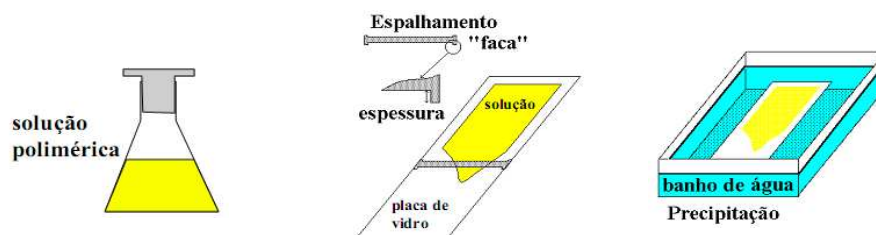
Figura 10 – Esquema da obtenção de uma membrana pelo processo de imersão-precipitação.
