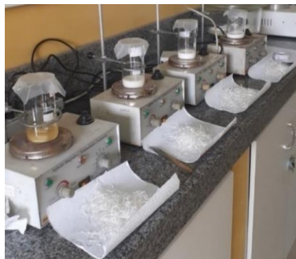
Figura 15 – Preparação das soluções de PA66 pura e seus híbridos (PA66/1% \text{TiO}_2 , PA66/3% \text{TiO}_2 e PA66/5% \text{TiO}_2 ) com a adição de \text{NH}_4\text{Cl} para obtenção das membranas.
