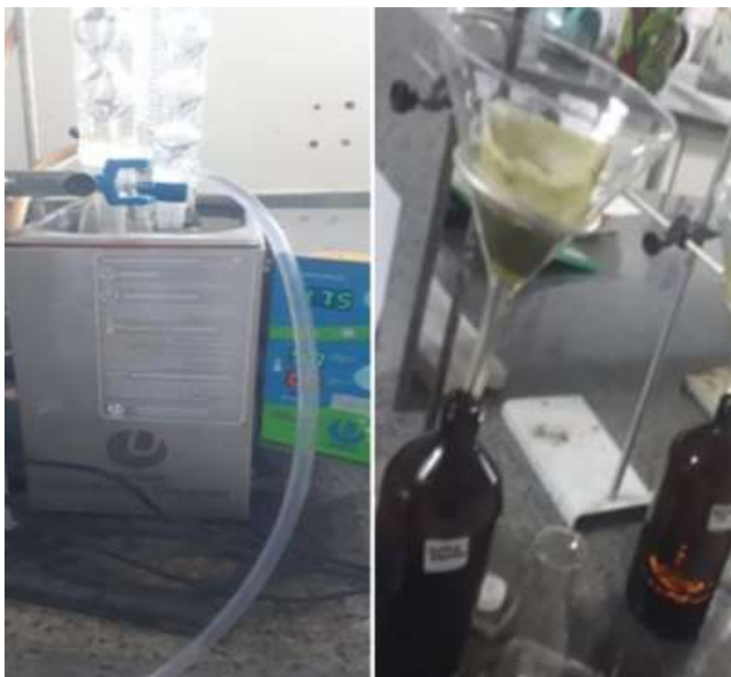
Figura 4 – Processo de extração ultrassônica e por esgotamento.
