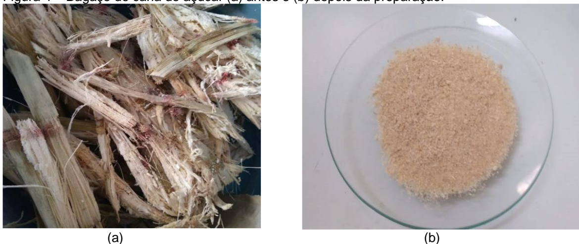
Figura 4 – Bagaço de cana de açúcar (a) antes e (b) depois da preparação.
