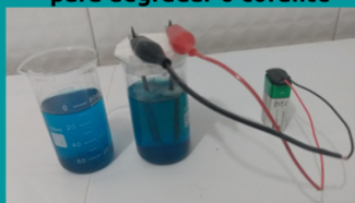
Figura 6 – Início da eletrólise do NaCl, para degradar o corante
