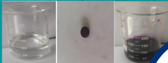
Figura 1- Preparação da solução de permanganato de potássio
