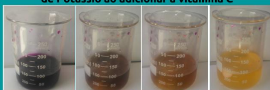
Figura 3- Mudança de cor da solução de Permanganato de Potássio ao adicionar a vitamina C
